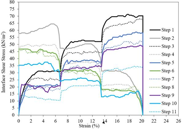
(d) 25% Sand: 75% Weathered Clay Shale
