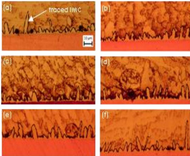
**Figure 1** IMC trace of (a) control SAC305, (b) 5 Gy, (c) 10 Gy, (d) 15 Gy, (e) 20 Gy, and (f) 25 Gy
