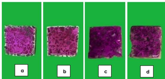
**Figure 11** Carbonation in concrete: (a) SZT, (b) TZT, (c) RTT, (d) CZT
