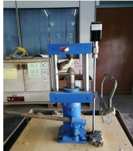
(d) Apparatus for measurement of point load strength, PLS
