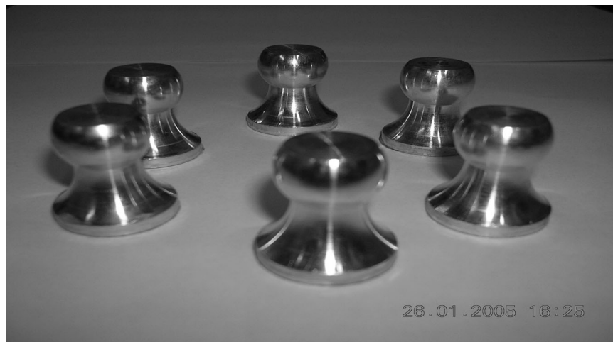
Rajah 3 Butang ( dolly ) yang digunakan dalam analisis kekuatan lekatan saduran nikel
