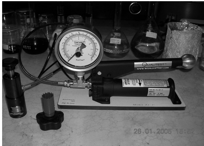
Rajah 2 Penguji lekatan mudah alih PosiTest Pull-Off Adhesion Tester
