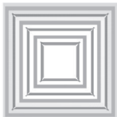
Rajah 7 Pandangan seluruh diafragma yang telah dipunarkan dengan menggunakan bentangan topeng pampasan penjuru sepanjang proses punaran hingga lengkap
