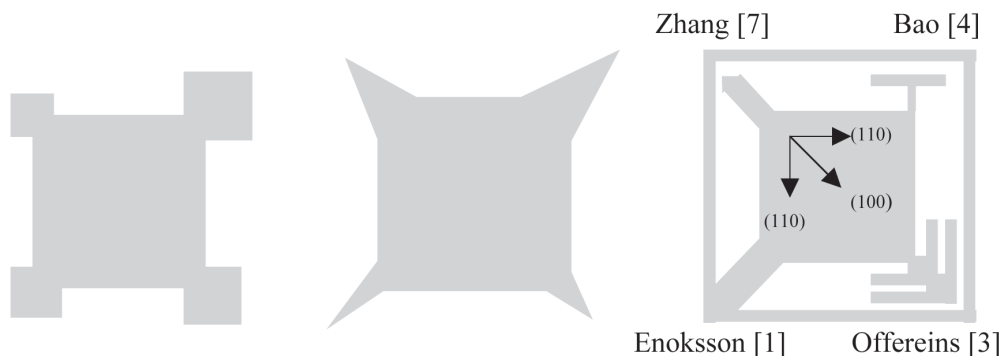
Rajah 1 Prinsip pampasan yang berbeza dalam melambatkan proses makan bawah penjuru pada struktur penjuru cembung [1], [3], [4] & [7].
