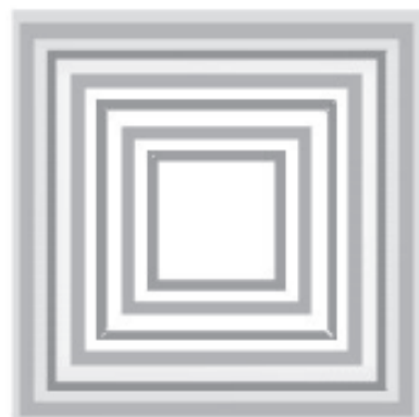
Rajah 7 Pandangan seluruh diafragma yang telah dipunarkan dengan menggunakan bentangan topeng pampasan penjuru sepanjang proses punaran hingga lengkap
