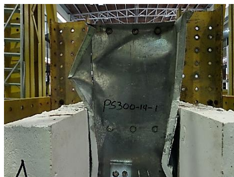
(d) CFS flange failure
